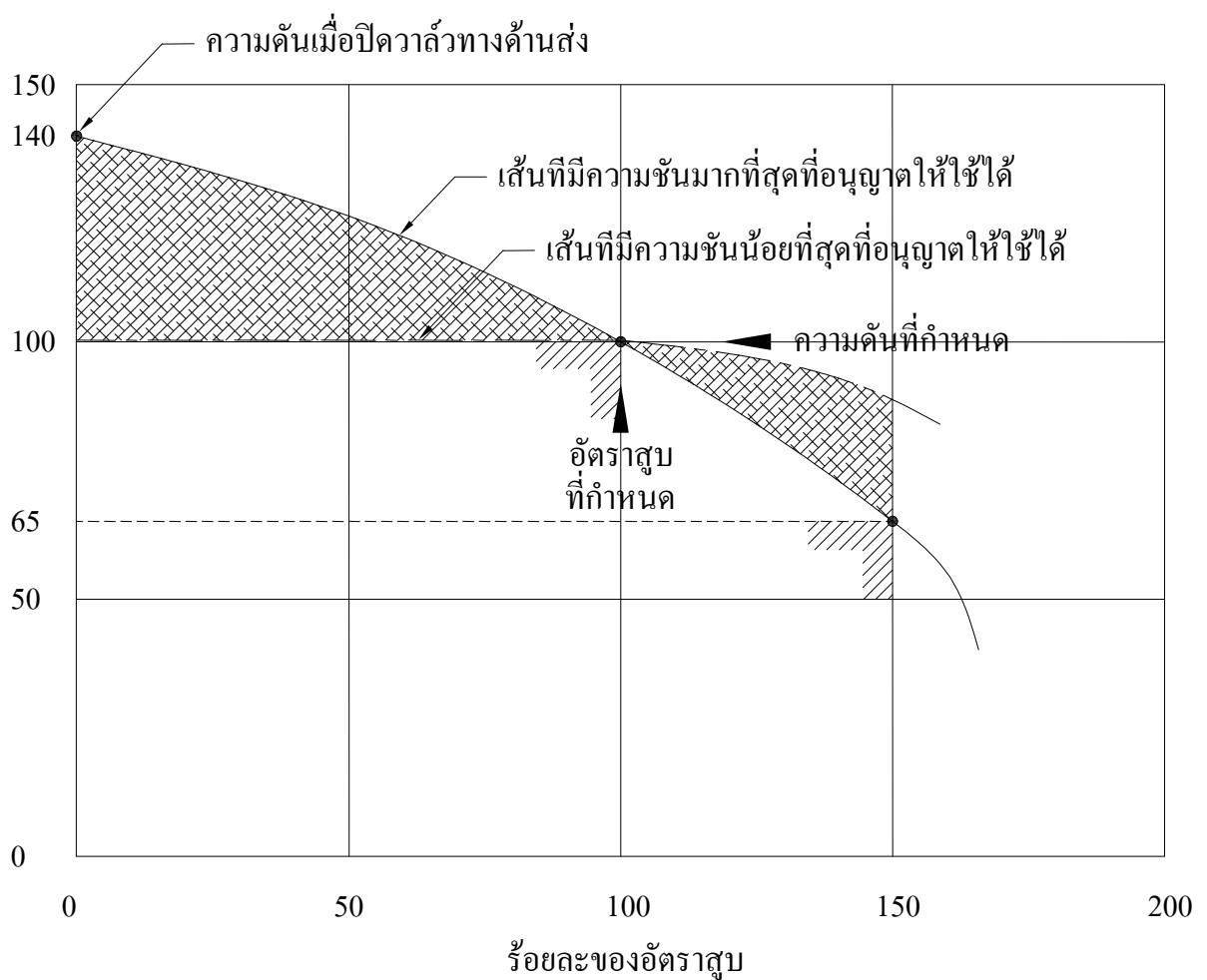
รูปที่ 1 เส้นกราฟแสดงคุณลักษณะของเครื่องสูบน้ำดับเพลิง
